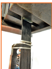
1 Unidirektional verstärkte CFK-Probe nach 25000 Zyklen Zugbelastung, davon 5000 bei bis zu 75 % der quasistatischen Materialfestigkeit.
